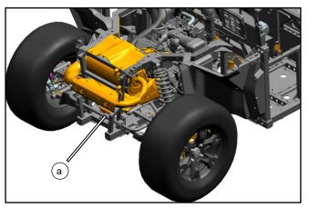
// Remove the muffler assy (a).
